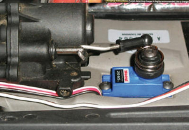
Das sollte dann so aussehen, wie rechts auf dem Servo. Jetzt noch die Schaltstange erst durch das Loch fummeln, dann noch den Kugelkopf auf die Servosaverkugel draufklicken und fertig ist der Einbau.
