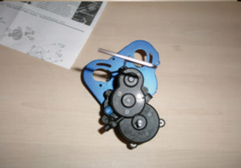
Als erstes lösen wir die 6 Inbusschrauben des Getriebes mit unserem 2 mm Inbusschlüssel...
