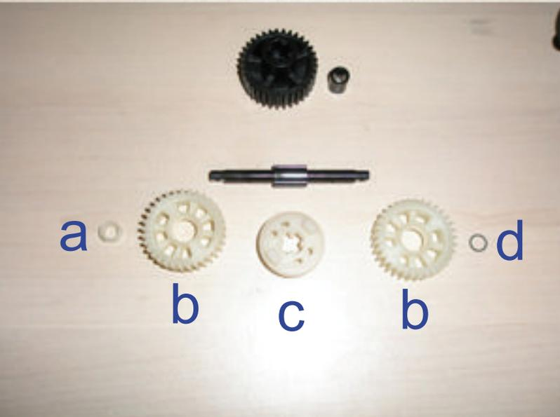
Als nächstes legen wir die Welle vor uns hin, und legen aus dem Beutel folgende Teile dazu; Kleine weisse Abstandshülse (a), 2 große Zahnräder (b), ein Mitnehmer (c), einen kleinen dünnen Teflonabstandshalter (d) sowie 4 x die größeren Kugellager (nicht im Bild!)...
