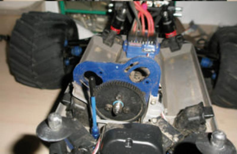
Jetzt einfach mit dem original E-Maxx 2.5mm Inbusschlüssel die 4 Schrauben vorne an den Motoren lösen und die Motoren nach hinten rausziehen. (Falls ihr noch die Serien 19Z Ritzel drauf habt, evtl diese mit dem 1,5mm Inbuss vorher abschrauben...
