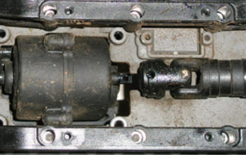
auch die hintere Welle kann man etwas verschieben. Also ziehen wir jetzt auch das hintere Gelenk aus dem Getriebe komplett raus. Nun ist das Getriebe frei und wir können es zur Seite legen...
