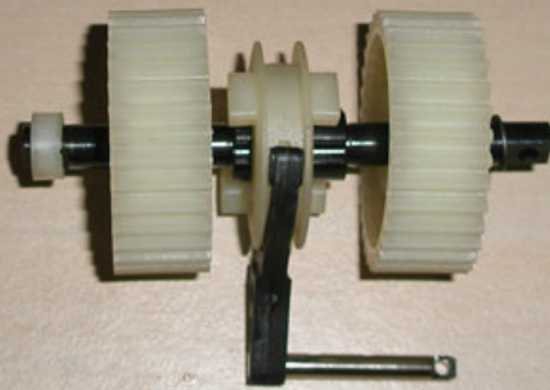
jetzt schieben wir (c) in die Mitte der Welle, dann links 1x (b), rechts 1x (b) aber Achtung! Die beiden Zahnräder (b) müssen unbedingt mit der tieferen Seite (da wo die beiden Streben zu sehen sind) nach innen auf die Welle, sonst kann der Mitnehmer (c) später nicht greifen!! Danach kommt dann links Teil (a) und rechts Teil (d) auf die Welle. Am Schluss legen wir die Schaltgabel in den Mitnehmer (c) ein (die liegt nur locker an), und das ganze sollte dann so aussehen...
