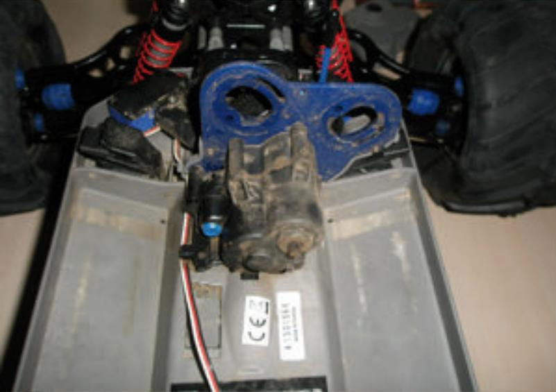
So sieht das Getriebe jetzt aus, wenn die Motoren raus sind...
