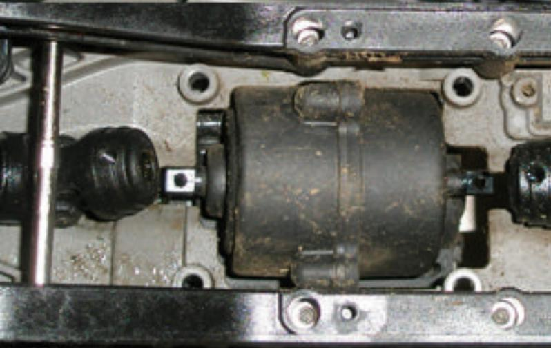
Nun kann man das vordere Gelenk einfach nach vorne schieben (da es verschiebbar ist), und so ganz von dem Getriebe lösen...
