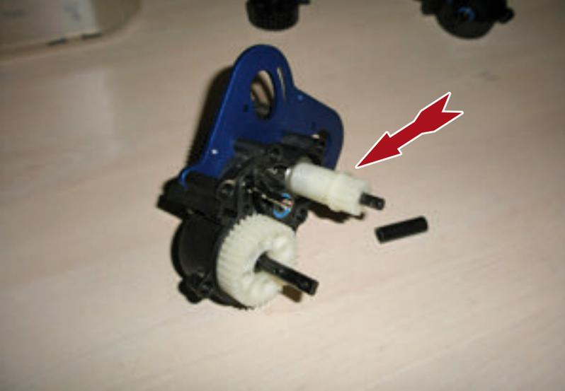
den ziehen wir ab, und schieben stattdessen eines der beiden länglichen Zahnräder wie auf dem Bild drüber. (Welches der beiden, müsst ihr selber entscheiden) - es liegen 2 verschieden Untersetze Zahnräder dabei, ich habe mich für das ganz kurze mit 13 Zähnen entschieden...
