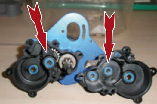
wir sollten jetzt die beiden kleinen Kugellager in die Öffnungen siehe Pfeile der beiden Gehäusehälften (1) und (2) mit dem Daumen eindrücken. (auf dem Bild sind die Lager schon drin)
