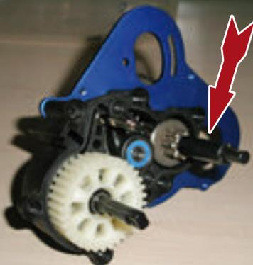
wir können dann das komplette Teil aus dem oberen Bild vorsichtig so wie es auf dem Bild oben liegt in die Hälfte (1) einführen. Die Schaltgabel kommt natürlich oben in den Ausschnitt. Auf dem Bild sehen wir jetzt noch einen schwarzen Abstandshalter auf der hinteren Welle (Pfeil)...
