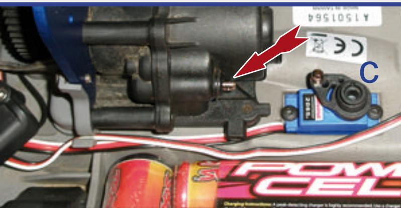
Jetzt das Getriebe einfach in umgekehrter Richtung wieder einbauen. Dann müssen wir noch den Servosaver (c) auf das Servo anschrauben (genau so, wie auf dem beiliegendem Zettel abgebildet)
