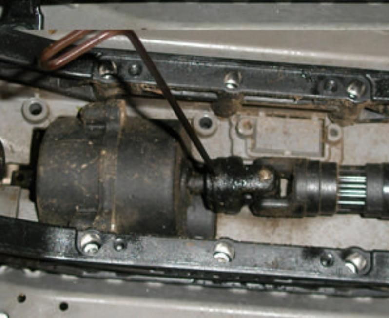
Jetzt wiederholen wir das ganze bei dem hinteren Gelenk. Dreht die Räder hinten solange, bis ihr die kleine Madenschraube im hinteren Gelenk sehen könnt. Diese lösen wir jetzt auch mit dem Inbusschlüssel und drehen sie wieder komplett raus...
