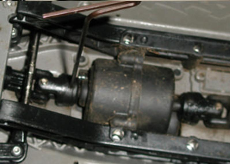
Jetzt kommt noch mal der 2,0 mm Maxx Inbuss von eben ins Spiel. Dreht die Räder vorne solange, bis ihr die kleine Madenschraube im vorderen Gelenk sehen könnt. Diese lösen wir jetzt mit dem Inbusschlüssel und drehen sie komplett raus...
