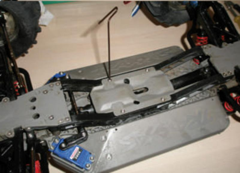
Mit dem original E-Maxx 2.0mm Inbusschlüssel lösen wir jetzt (oder eben vorher, Reihenfolge ist egal), die 4 Schrauben der Bodenplatte...
