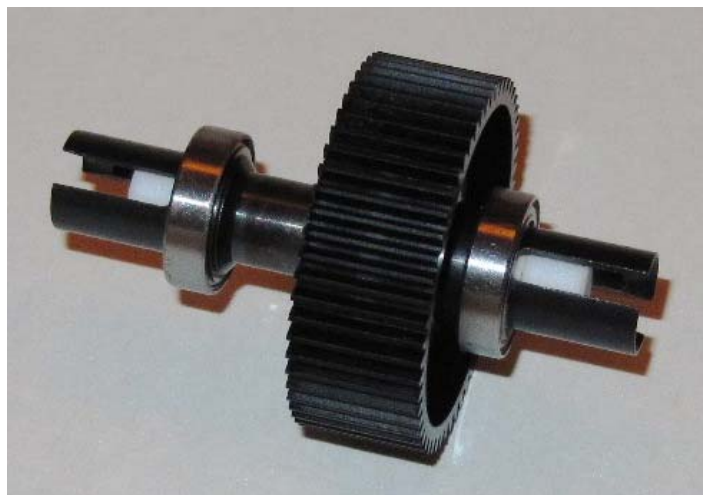
Abbildung 4: fertiges hinteres Differential
