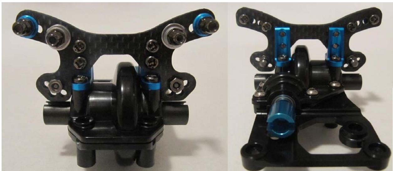
Abbildung 24: vordere Getriebebox mit Dämpferbrücke
