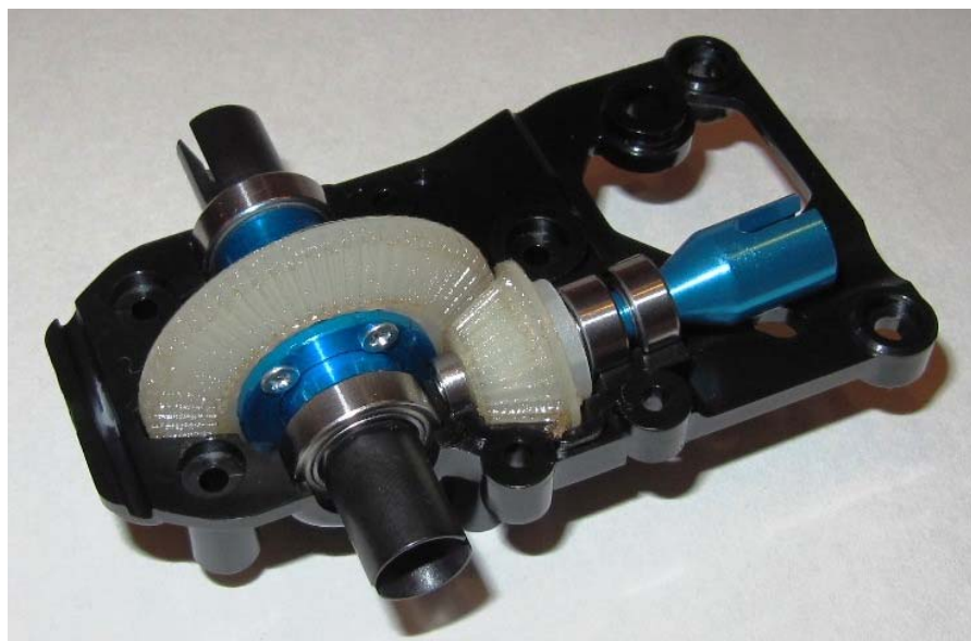
Abbildung 22: vordere Getriebebox mit Freilauf
