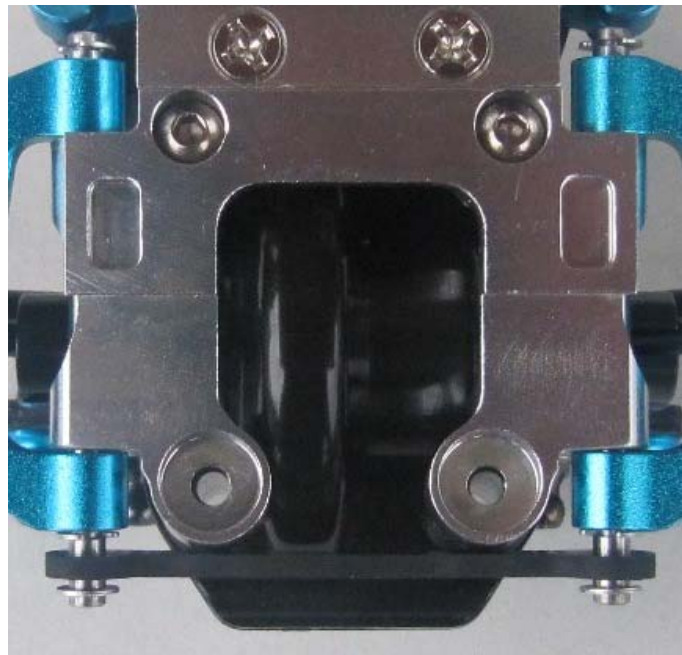
Abbildung 29: Achsschenkel vorne eingebaut
