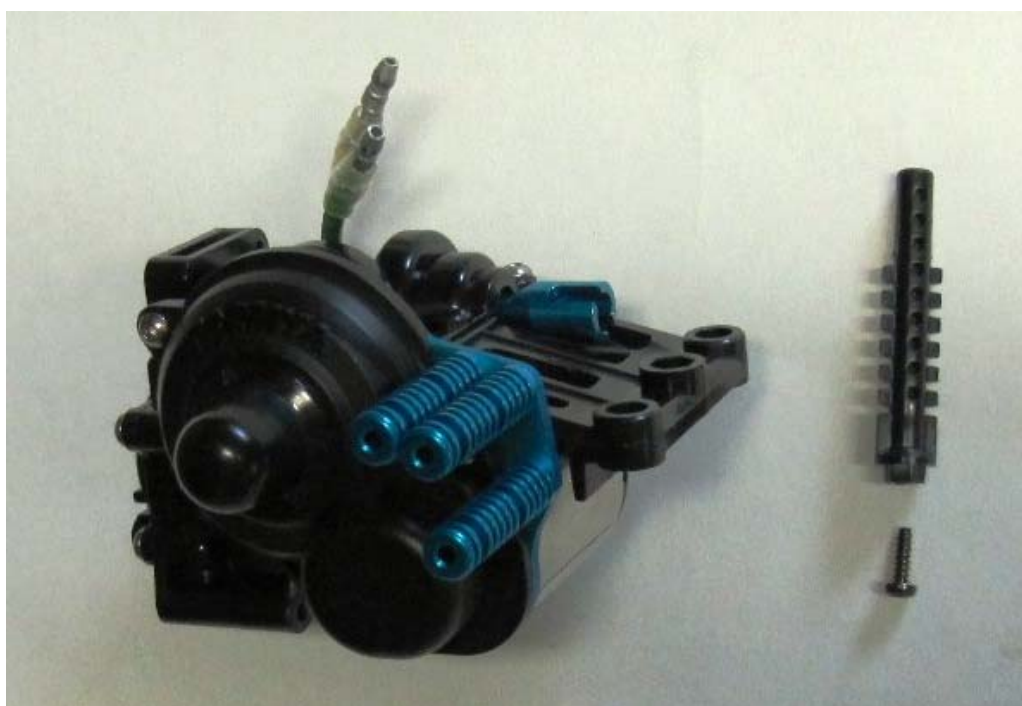
Abbildung 11: fertige hintere Getriebebox mit optionalem Karosseriehalter
